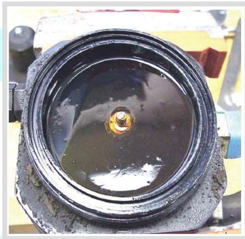
Εναπόθεση λαδιού από τον συμπιεστή του CNG στο ρυθμιστή πίεσης καυσίμου
